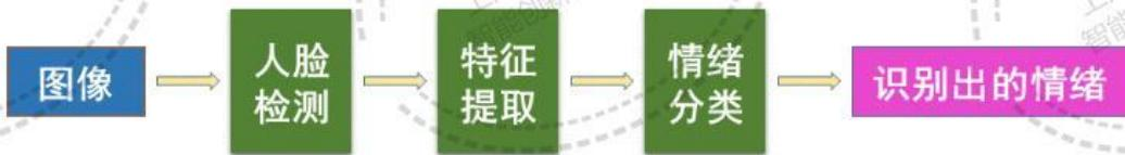
待测图像输入程序后，会经过人脸检测确定图像中的所有人脸，确定为感兴趣区域，之后经过卷积神经网络提取出图像中的特征，然后再利用特征对情绪进行分类，判断出各种情绪的置信度。最后将分类结果与人脸检测结果结合，将不同的情绪标签绘制在人脸附近，我们就能看到带着情绪标签的图像了。
